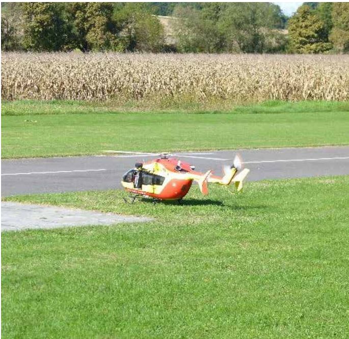
Rettungshubschrauber EC 145: Nachbaumaßstab 1:6 - Fluggewicht 10 kg E-Antrieb 6 kW
