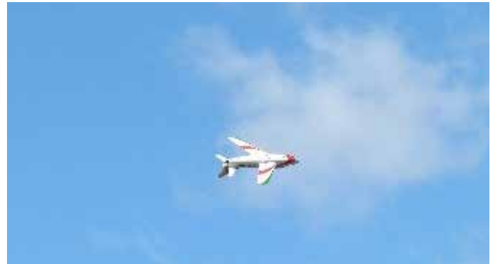
Fiat G91: Nachbaumaßstab 1:4 - Länge 2,5 m - Spannweite 2,3 m - Fluggewicht 19 kg Turbine 170 N Schub
