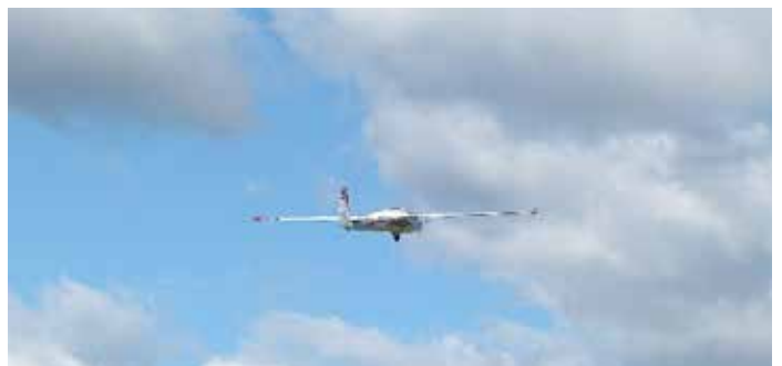
Kunstflugsegelmodell: Nachbaumaßstab 1:2 Länge 2,8 m - Spannweite 6 m - Fluggewicht 16 kg E-Antrieb 8 kW
