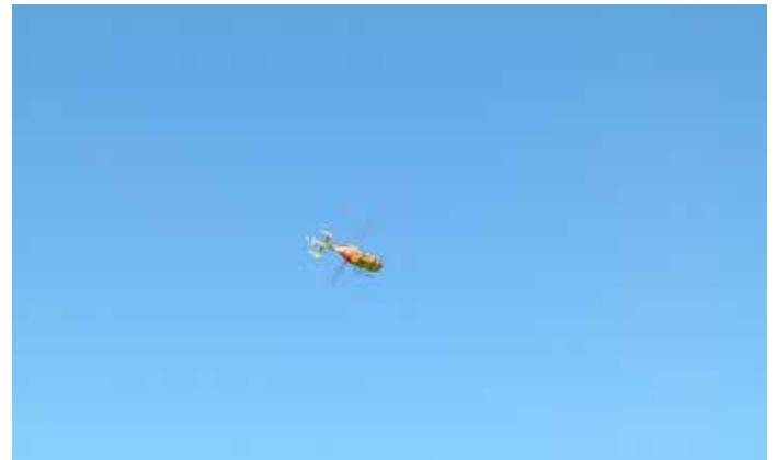
Rettungshubschrauber EC 145: Nachbaumaßstab 1:6 - Fluggewicht 10 kg E-Antrieb 6 kW
